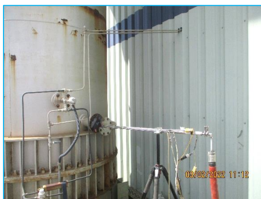
ภาพที่ 3.11 การตรวจวัด Ammonia ( \text{NH}_3 ) จากแหล่งกำเนิด
